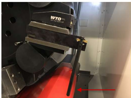
1.) 推动扳手翘起刀板定位面
